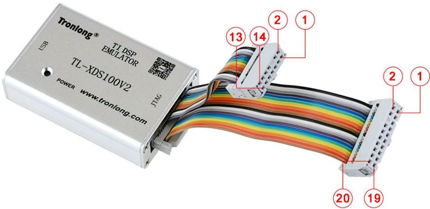
图 4 20-20-14pin JTAG 转接排线
