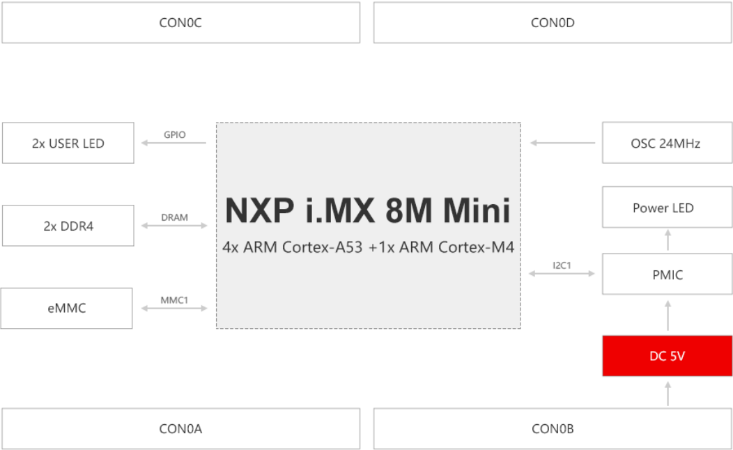
图 5 核心板硬件框图
