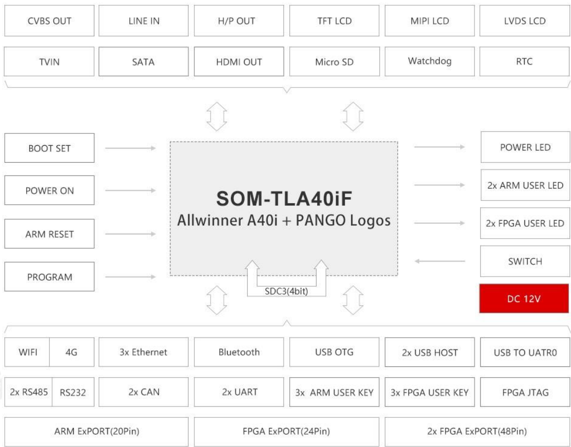
图 7 评估板硬件框图
