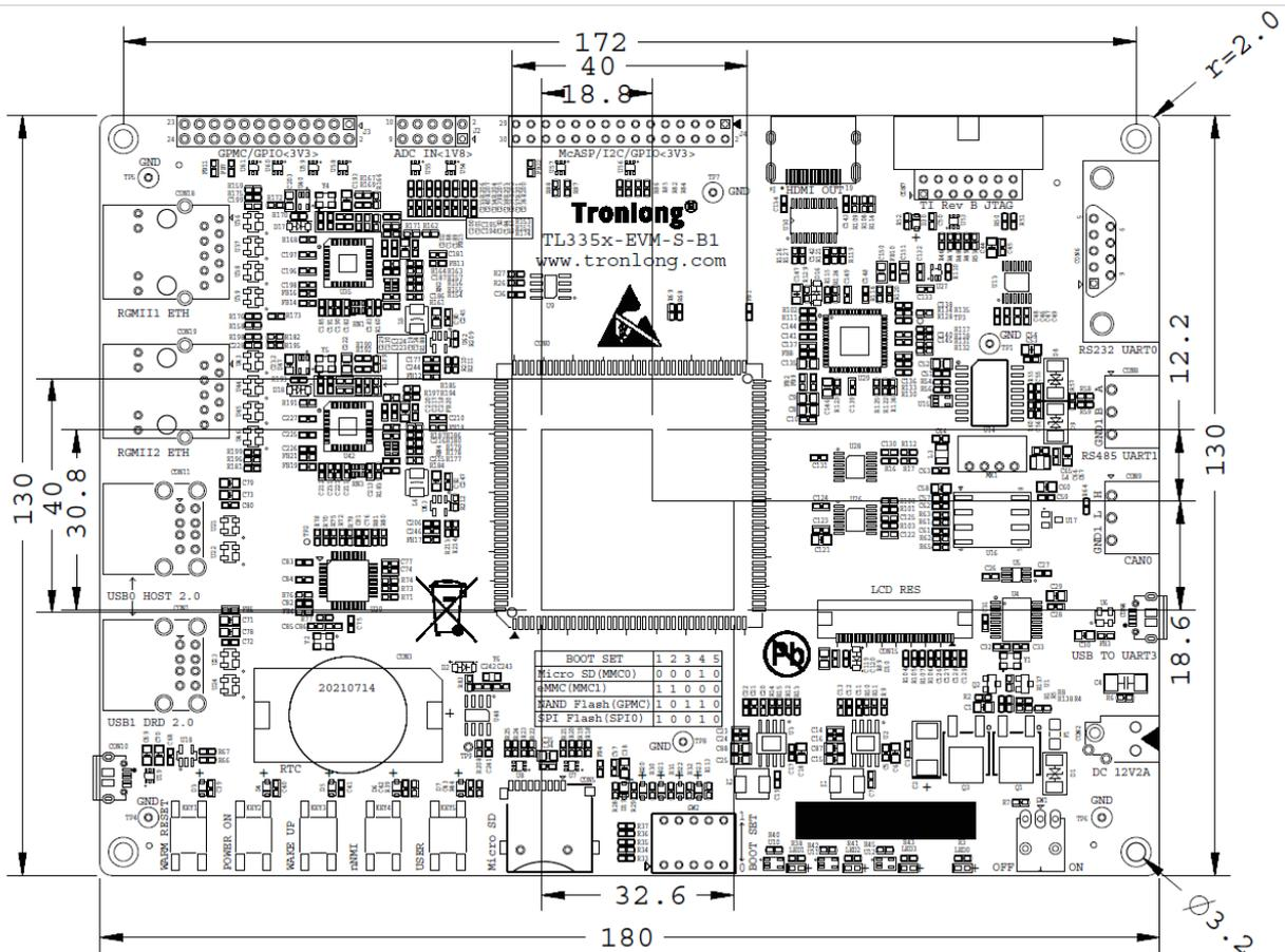
图 12 评估底板机械尺寸图
