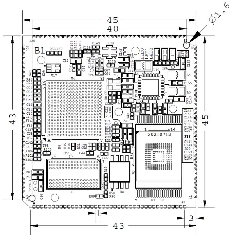
图 11 核心板机械尺寸图（顶层透视图）
