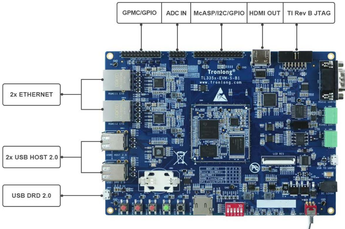
图 9 评估板硬件资源图解 1
