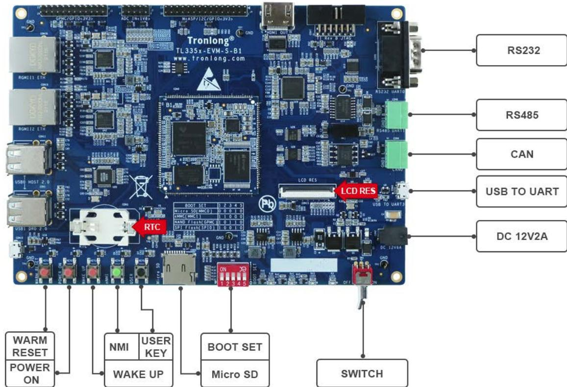
图 10 评估板硬件资源图解 2
