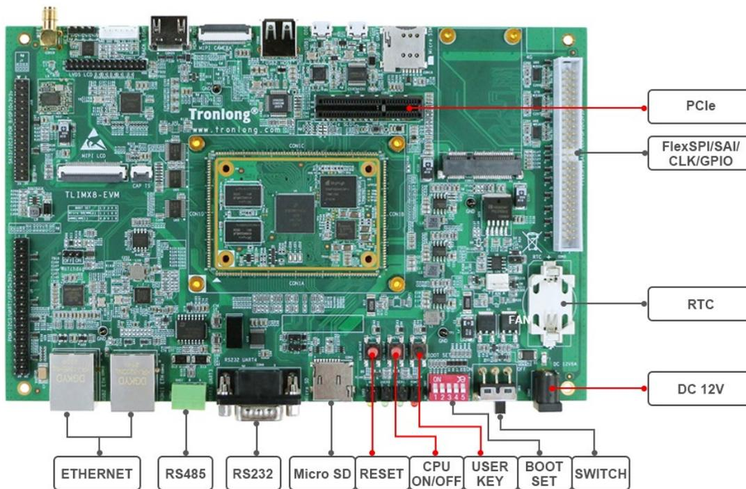
图 7 评估板硬件资源图解 2
