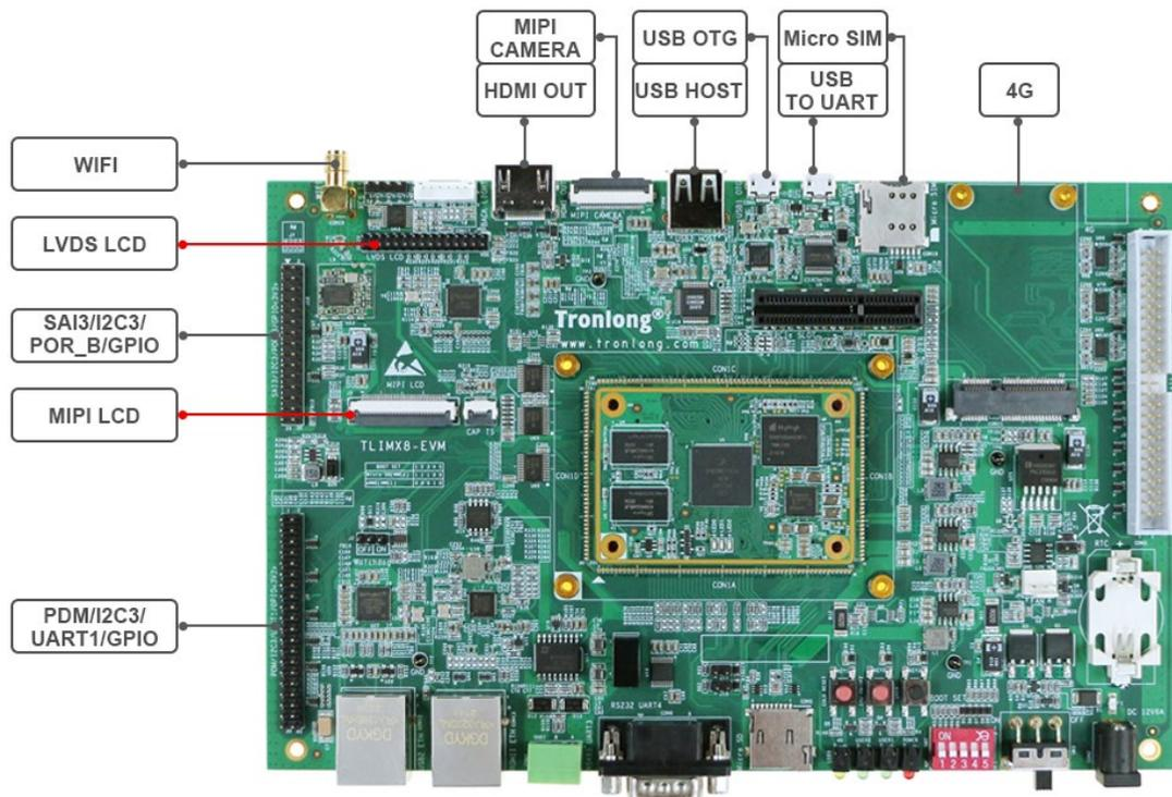
图 6 评估板硬件资源图解 1
