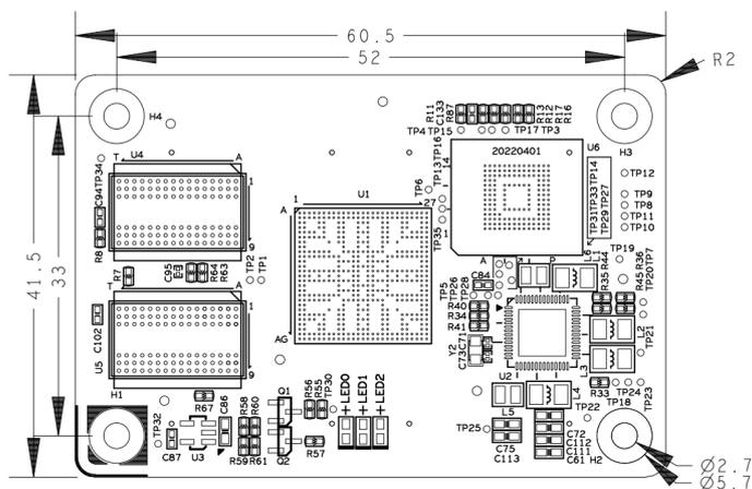
图 8 核心板机械尺寸图
