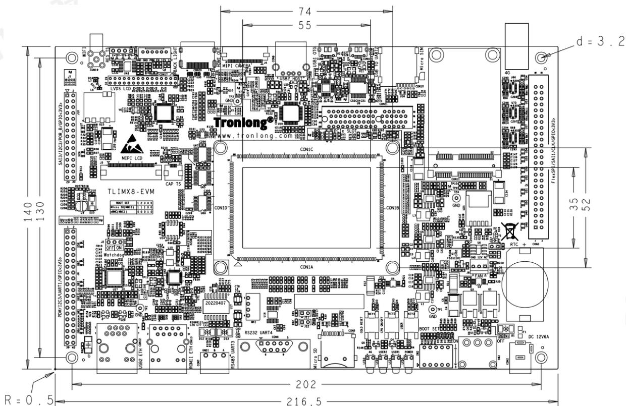
图 9 评估底板机械尺寸图
