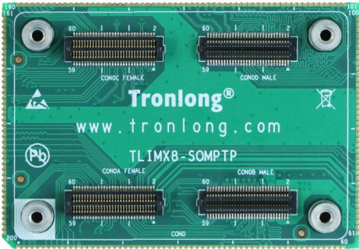
图 10 TLIMX8-SOMPTP 转接板
