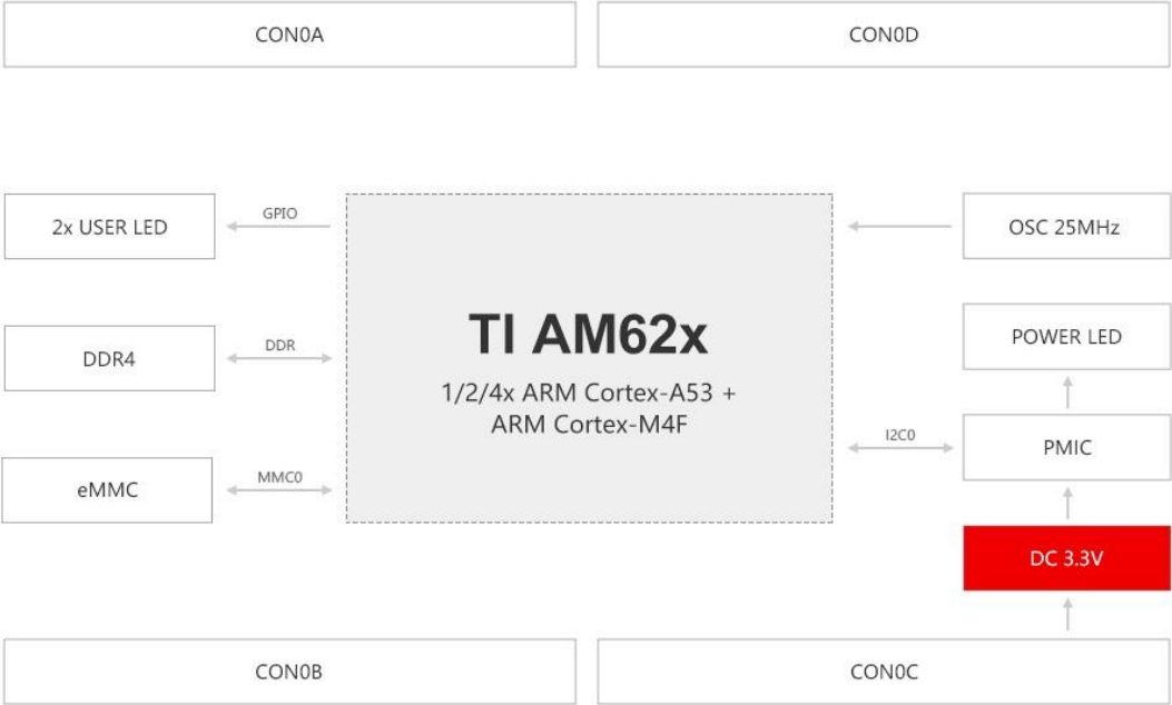
图 5 核心板硬件框图
