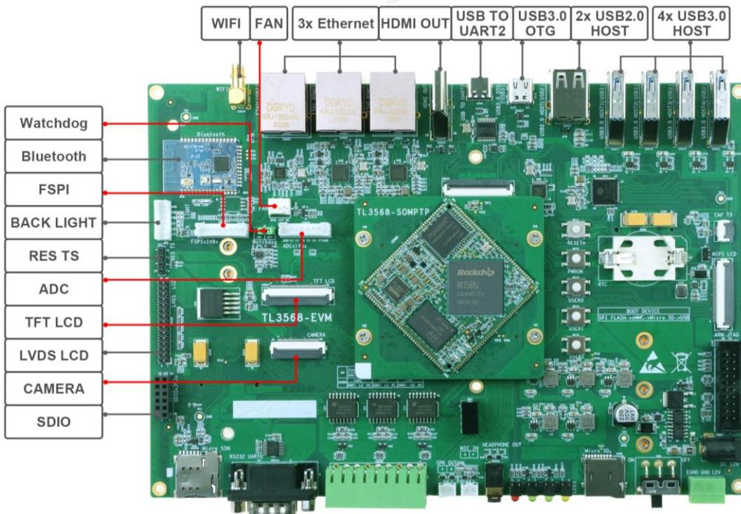
图 9 评估板硬件资源图解 1
