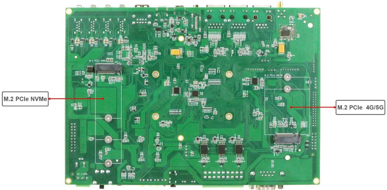
图 11 评估板硬件资源图解 3
