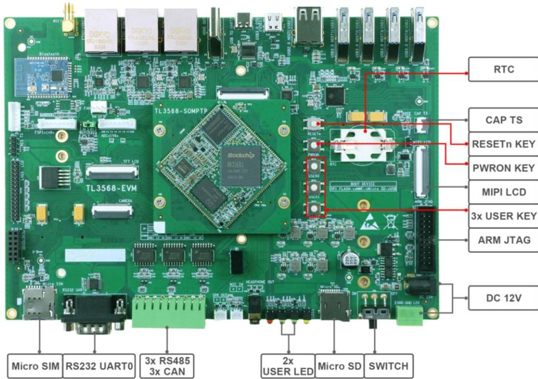
图 10 评估板硬件资源图解 2
