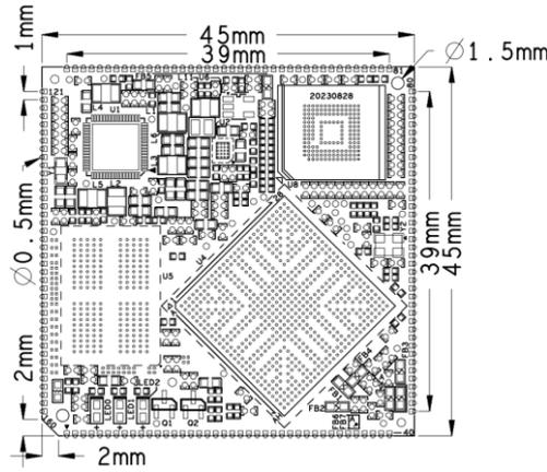
图 12 核心板机械尺寸图
