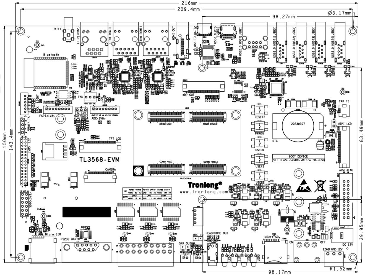
图 13 评估底板机械尺寸图
