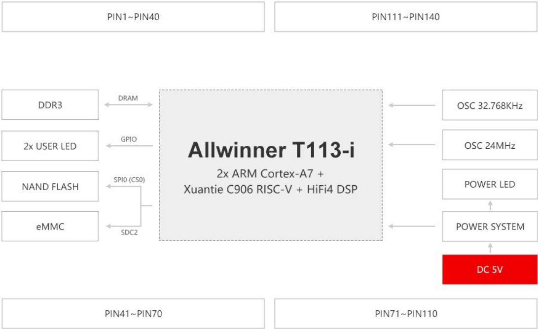
图 5 核心板硬件框图
