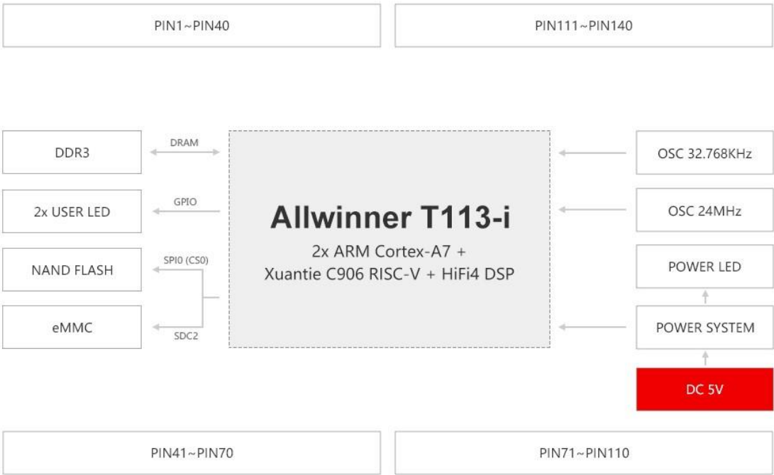
图 5 核心板硬件框图
